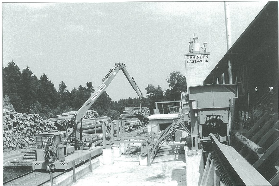
Moderne Kran- und Entrindungsanlage, Sägewerk Dahinden.
